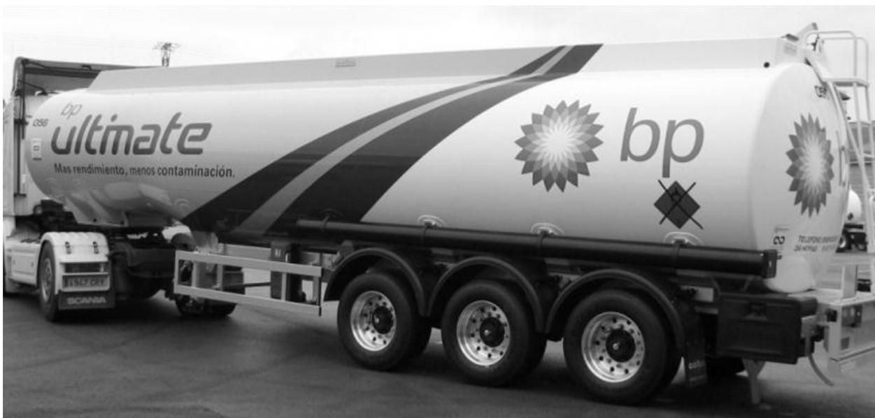
Рисунок 3. Полуприцеп-цистерна ППЦ-40.
